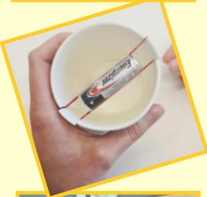
3. Spanne den Gummiring in den Becher, indem du die Enden in die Laschen einhängst!
