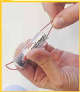
2. Befestige den Gummiring mit Klebeband entlang der Batterie, sodass an den Enden der Gummiring drüber steht!
